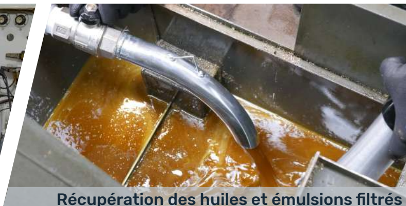
Aspiration et séparation des huiles et copeaux
