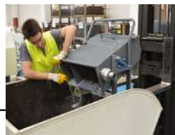
Cuve extractible pour le traitement des copeaux aspirés
