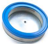
Filtre absolu HEPA Idéal pour poussières fines Efficacité 99,995% à 0,18 micron
